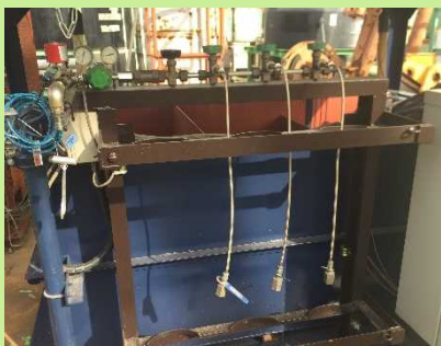
炭酸ガスポンベ取付部 (3本) (夏季はカバー等により温度対策を推奨します)
