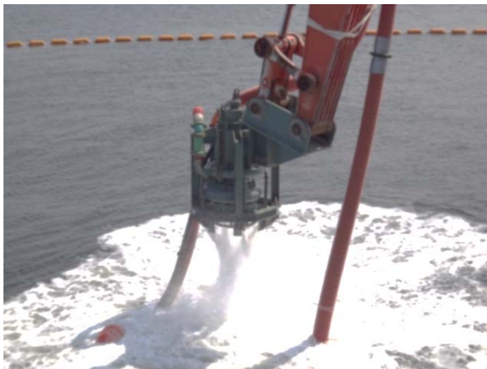
ジェット水 噴射試験状況(ジェット水により解泥)
